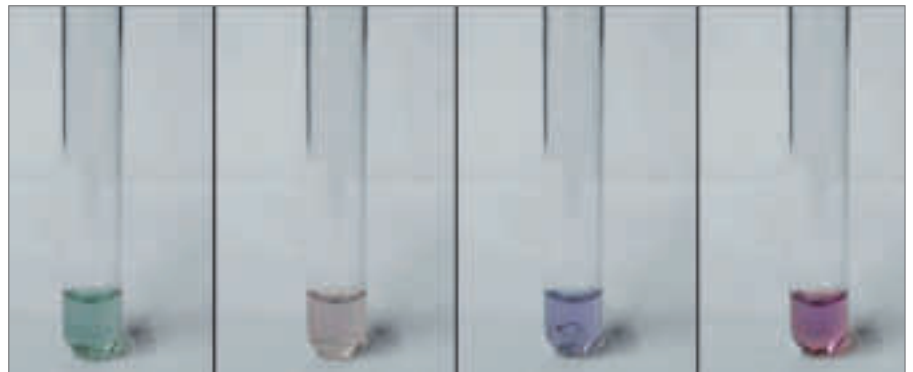
Figure 8: Résultat de la coloration utilisant la réaction BCA (Laboratoire Pierce) sur des solutions de protéines à des concentrations de 5 µg/mL, 50 µg/mL, 100 µg/mL et 125 µg/mL de BSA.
