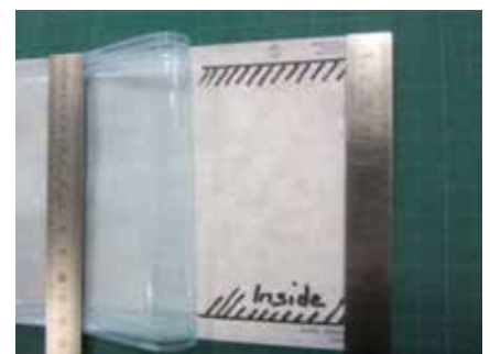
Abb. E.1 Sauber erscheinender Peel ohne Abfaserung des Papiers in Richtung Innenseite.
