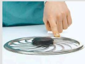
Les joints externes des porte filtres doivent être en contact avec la surface (contrôle de la planéité)
