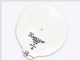
Filtre non endommagé (pas de plis, de trous, de fissures ou de craquelures)
