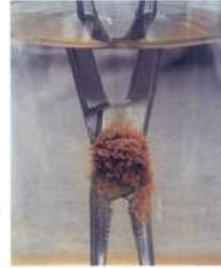
Formation de rouille sur un instrument plongé pendant plusieurs heures dans une solution saline.
