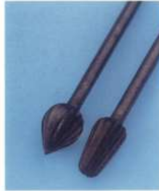
Colorations, corrosions et incrustations sur des mèches et des lames ayant subit des traitements inadaptés.
