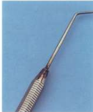
Corrosions par frottement dues à une détérioration de la couche de passivation.
