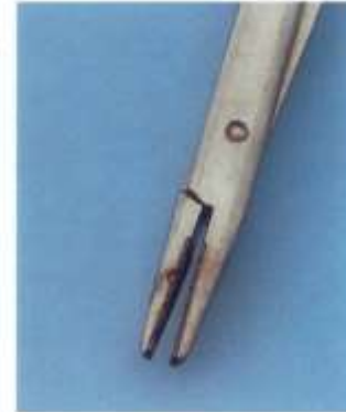
Corrosions par frottement dues à une détérioration de la couche de passivation.
