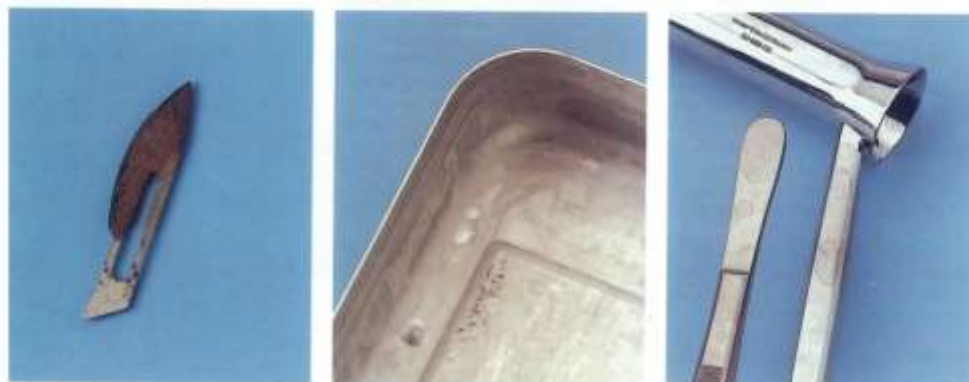
Rouille sur une lame de bistouri non appropriée pour le lavage en machine.
