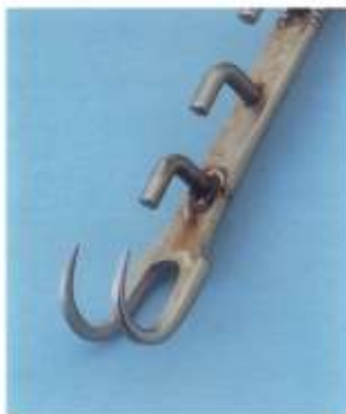
Incrustations sur un instrument chirurgical.
