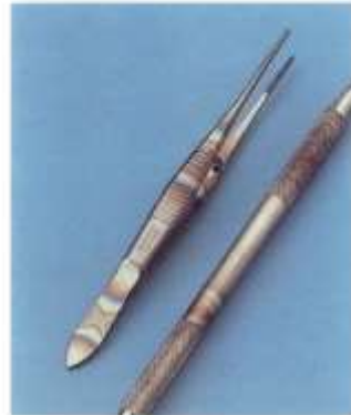
Corrosion par contact provoquée par un traitement sur un rack en laiton.
