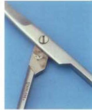
Corrosion par frottement due à un manque de lubrifiant.
