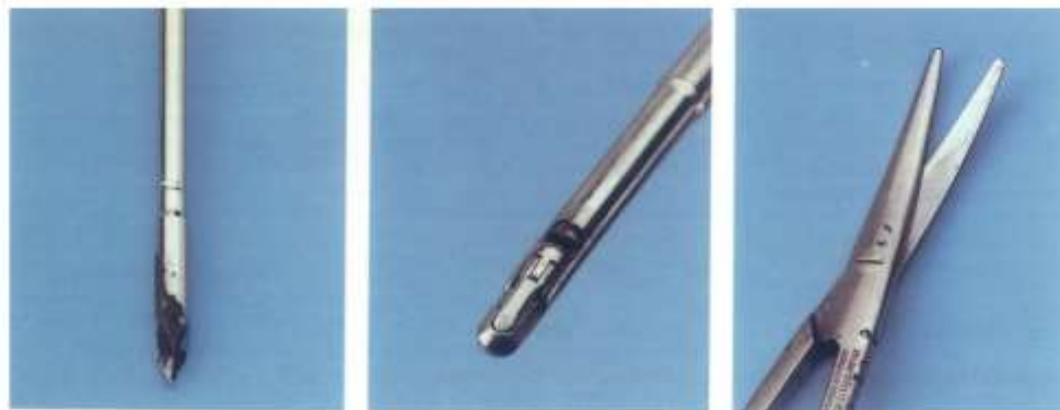
Piqûres de corrosion dues aux chlorures.
