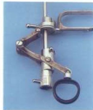
C: Décapage de la couche anodisée de la poignée par des nettoyages trop alcalins.
