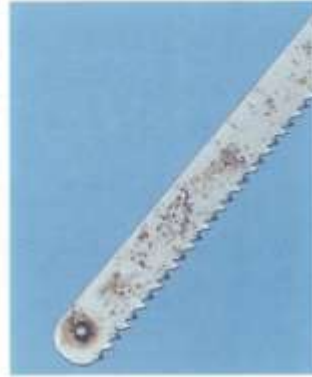
Colorations, corrosions et incrustations sur des mèches et des lames ayant subit des traitements inadaptés.
