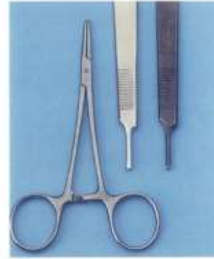
Instruments noircis - en comparaison avec l'instrument du milieu dont la surface est normale.
