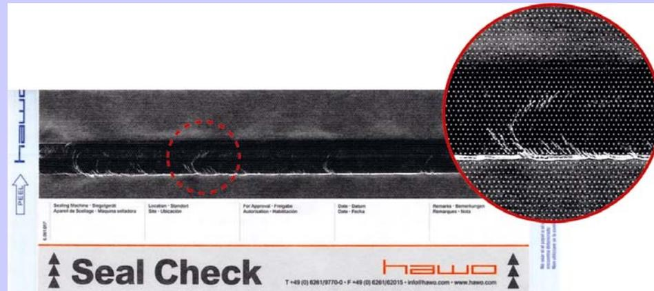
**Soudure non validée, température (et/ou) pression de soudage trop haute. Micro-fissures du film plastique.**
