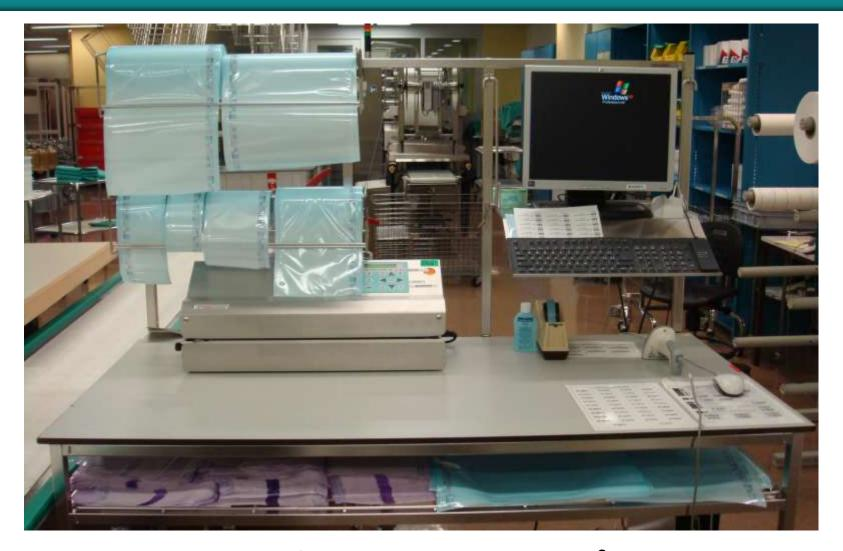
Température de scellage 150° C Importance de la coordination des vitesses de défilement
