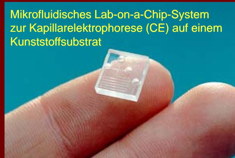
Mikrofluidisches Lab-on-a-Chip-System zur Kapillarelektrophorese (CE) auf einem Kunststoffsubstrat
