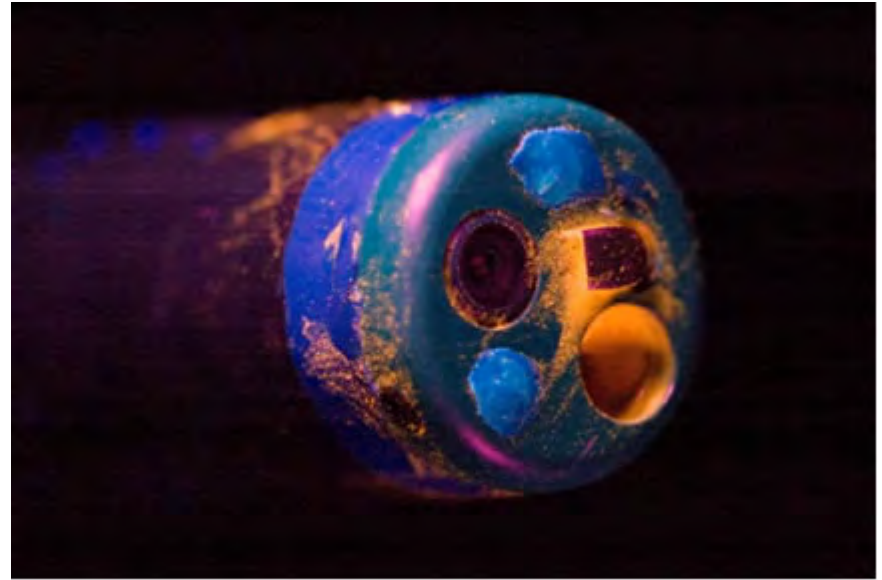
(b) Endoscope après utilisation, sous lumière UV avec solution de riboflavine
