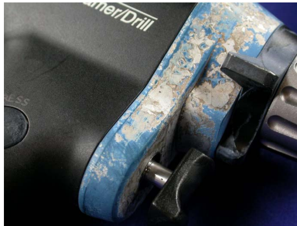
Alluminio con segni di corrosione
