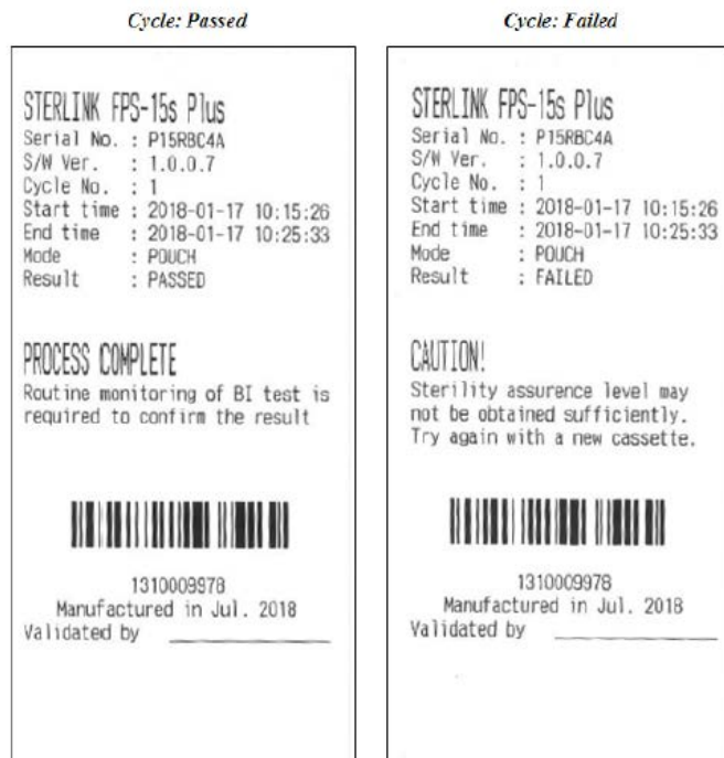
Figure 7.2 Rapports synthétiques pour un cycle réussi (PASSED) et un cycle raté (FAILED)
