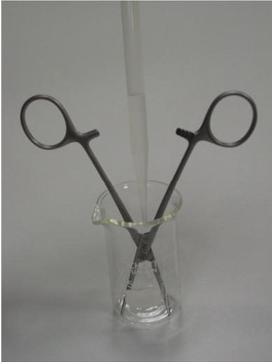
Zur Probengewinnung wird jedes Instrument in ein 50 ml Becherglas (hohe Form, z.B. Artikel C123.1, Carl Roth GmbH, Karlsruhe) gestellt und zwei Milliliter der SDS-Lösung über den Gelenkbereich zupipettiert. (Handschuhe tragen!)
