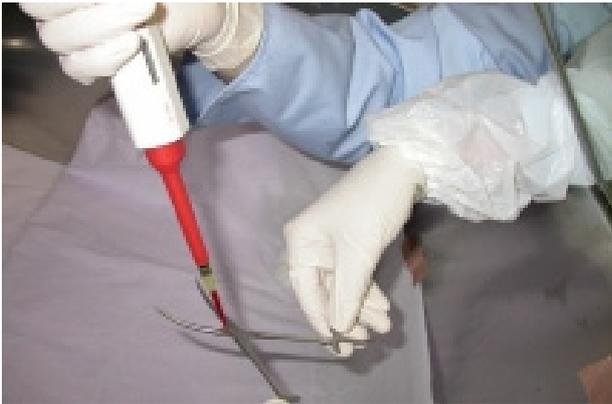
Das Prüfinstrument wird fünfmal geöffnet und geschlossen, um eine gleichmäßige Verteilung der Kontamination zu erreichen.
