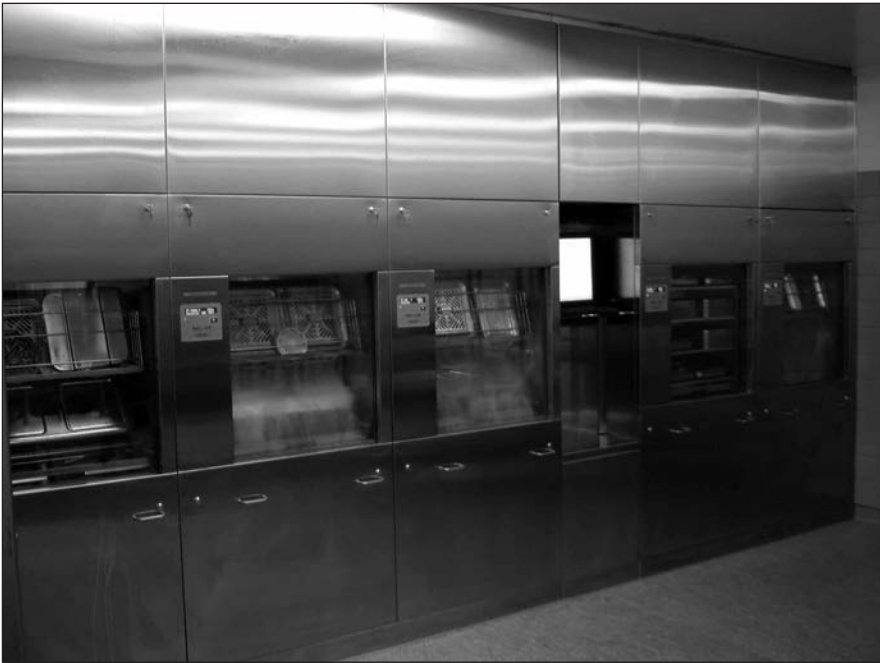
Fig. 3 Des portes vitrées rendent les processus de nettoyage et de désinfection d'autant plus transparents: pour traquer les appareils mal chargés, un coup d'œil en temps réel vaut mieux que de longs discours théoriques!
