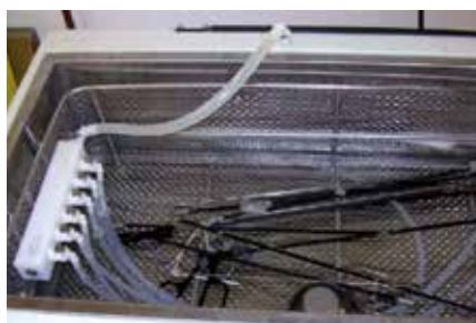
Abbildung 3 Ultraschallbecken mit Spülschläuchen.
