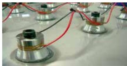
Fig. 2 Transducteurs piézoélectriques.
