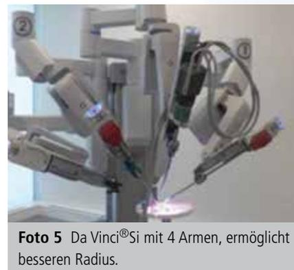
**Foto 5** Da Vinci®Si mit 4 Armen, ermöglicht besseren Radius.
