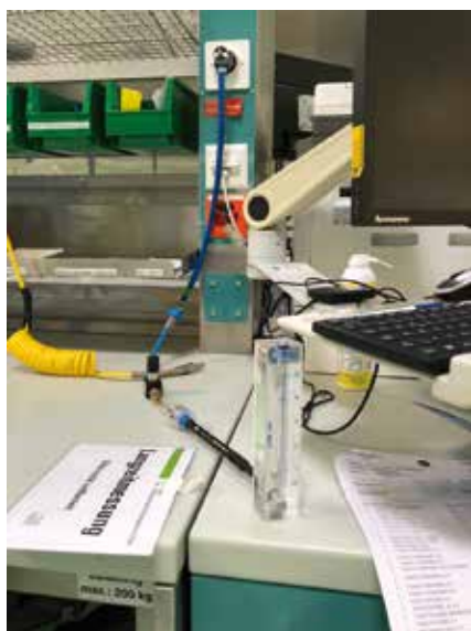
Figura 6 Filtro a carbone attivo. Il filtro è rimasto collegato per 24h al flusso di aria compressa.
