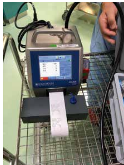
Figura 3 Apparecchio Lighthouse Solair S3100 utilizzato durante le analisi delle particelle. Qui ci troviamo in zona pulita.
