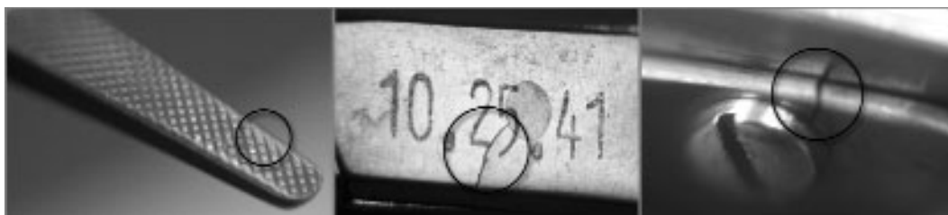
Exemples de détériorations d'instruments
