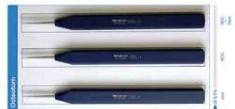
Abb. 13 Osteotom mit spezieller Oberflächenvergütung (von unten nach oben: neuer Zustand, nach 48 Zyklen Reinigung mit tX, nach 48 Zyklen Reinigung mit tX und Dampfsterilisation).
