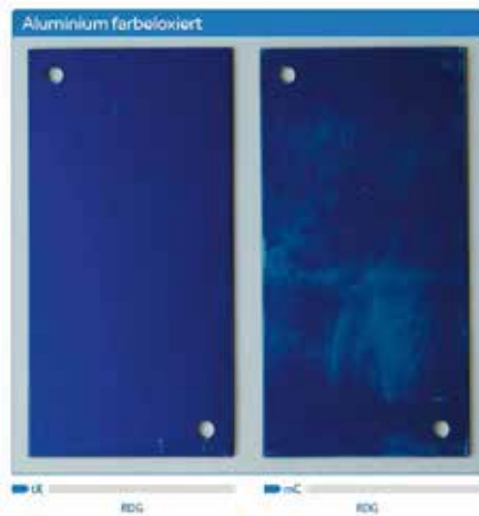
Abb. 10 Aluminium farbeloxiert nach 48 Zyklen Reinigung ohne Dampfsterilisation mit Testprodukt tX links und Testprodukt mC rechts.
