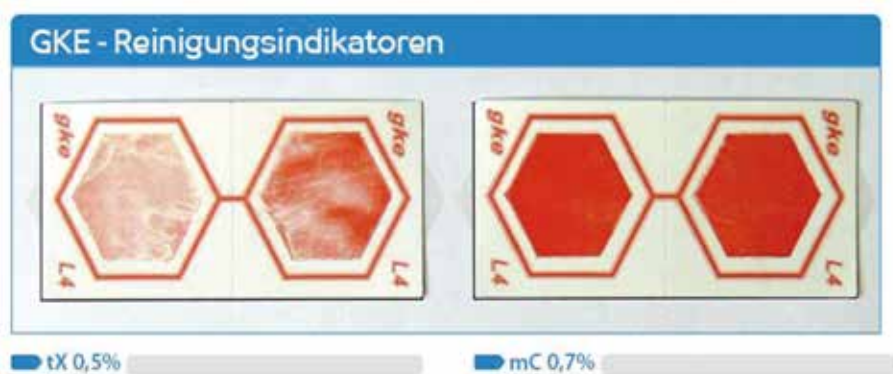
Abb. 6 Bewertung der Reinigungsleistung mit gke-Indikatorsystem gke-L4.
