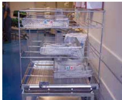
Abb. 3 Beladungswagen mit drei Testsieben bestückt mit diversen Reinigungsindikatoren und Crile- Klemmen.
