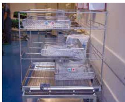
**III. 3** Support de charge contenant 3 plateaux tests garnis de divers indicateurs de nettoyage et de pinces Crile.
