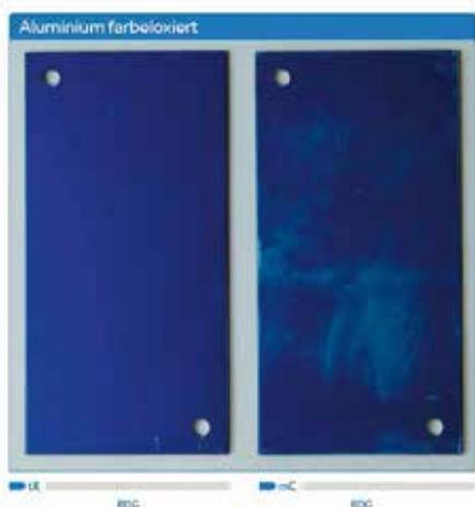
**III. 10** Aluminium anodisé de couleur après 48 cycles de nettoyage sans stérilisation à la vapeur; produit test tX à gauche; produit test mC à droite.
