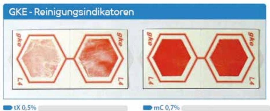
III. 6 Evaluation de la performance de nettoyage à l'aide du système indicateur gke (gke-L4).
