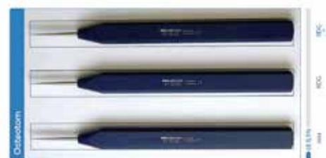
**III. 13** Ostéotome avec traitement de surface spécial (du bas vers le haut: état à neuf, après 48 cycles de nettoyage avec tX, après 48 cycles de nettoyage avec tX et stérilisation à la vapeur).
