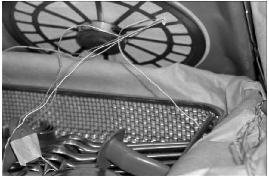
Abb 1: empfohlene Positionierung der Thermologger
