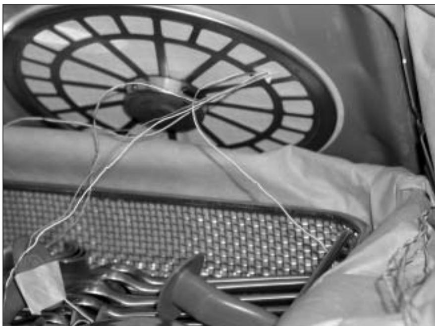
Graphique 1 : Le positionnement recommandé des capteurs de température
