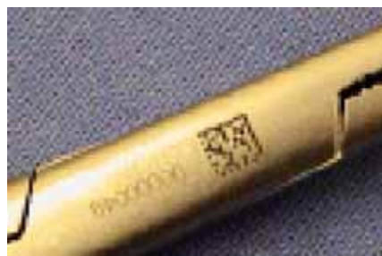
Fig. F.7 L'encodage ECC 200 est le plus répandu pour l'obtention d'un Data Matrix.
