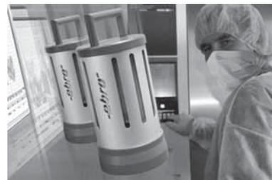
Der EB1-15-Datenlogger liefert ein klares Ergebnis beim täglichen Bowie-Dick-Test (Luftentfernungs- und Dampfdurchdringungstest nach DIN EN 285 und EN ISO 11140-4).
