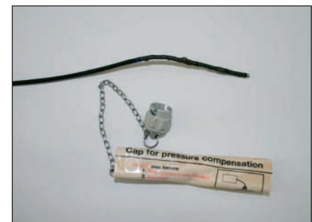
Abb. 16 In einer Autoklave mit Wasserdampf sterilisiertes Endoskop.
