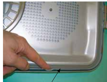
Deckeldichtung: Richtiger Sitz. Ohne Bruchstellen/Verformungen.
