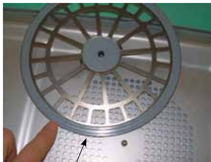
Filterhalterung: Passend zum Container und zum Filtertyp Dichtungen intakt.
