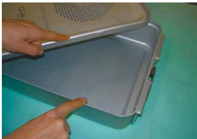
Dichte: Deckel Keine Verformungen/Dellen an den Verschlusskanten.
