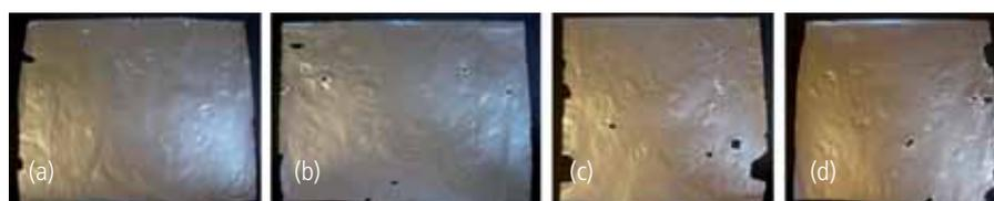
Foto 6 (a) ohne Entgasung; (b) Entgasung = 1 Minute; (c) Entgasung = 3 Minuten; (d) Entgasung = 5 Minuten.
