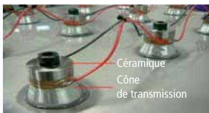
Fig. 2 Transducteurs piézoélectriques. Cuve de nettoyage équipée de transducteurs qui convertissent l'énergie électrique en énergie mécanique.
