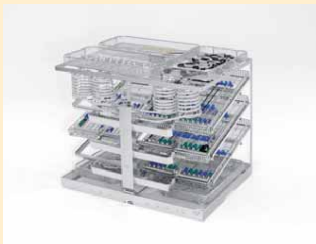
Photo 2 Support de chargement MIC-TOP de Belimed : quelques manipulations simples suffisent à réunir les plateaux légers et modulaires et à les accoupler.
