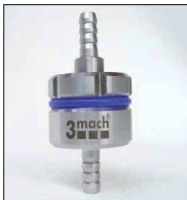
III. 2 Piège à particules 3mach® et analyse de la charge particulaire.
