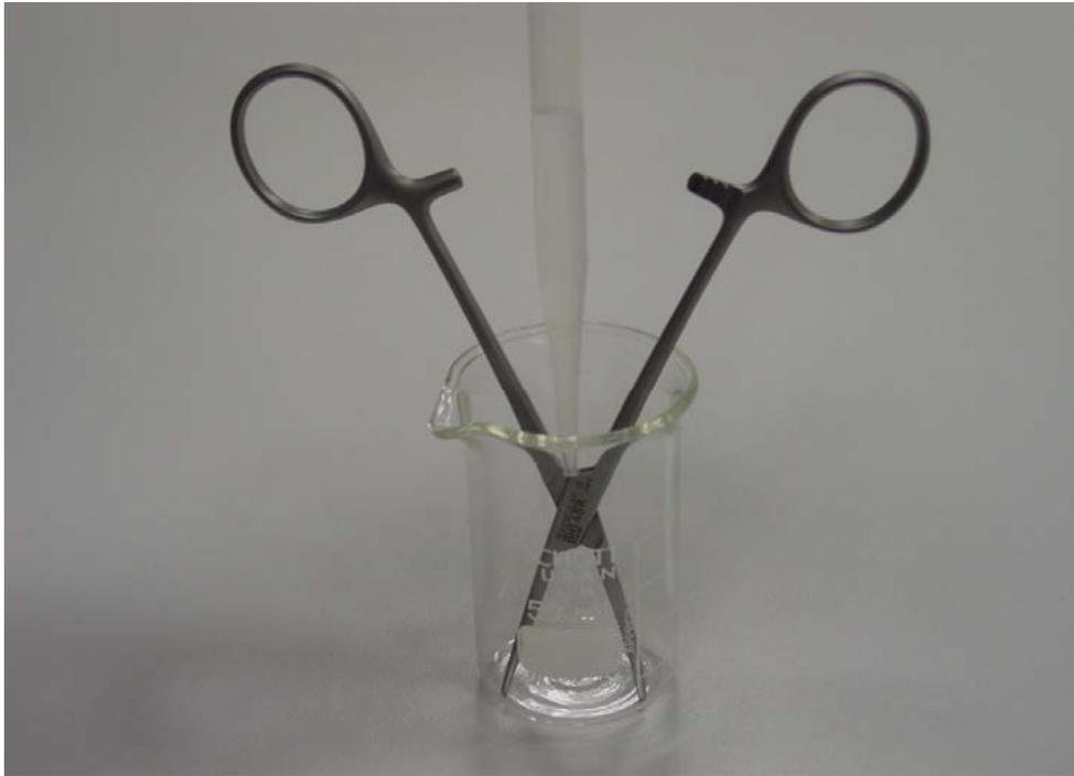
Zur Probengewinnung jedes Instrument in ein 50 ml Becherglas (hohe Form, z.B. Artikel C123.1, Carl Roth GmbH, Karlsruhe) stellen und 2 mL SDS-Lösung über den Gelenkbereich pipettieren.
