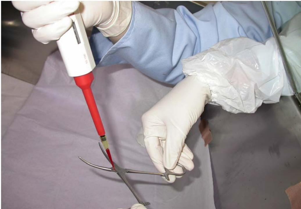
Zur Kontamination heparinisiertes Schafblut mit 10% Aqua bidest. verdünnen. Die Schafblutlösung mit 1,5 I.E Protaminsulfat je 1 mL Blut gerinnungsfähig machen. Pro Instrument 100 µl ins Gelenk pipettieren.
