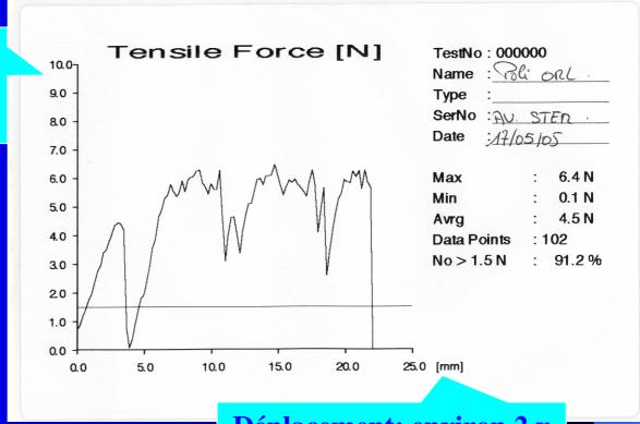
Déplacement: environ 2 x largeur de la soudure testée
