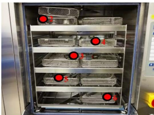
Fig. 3 Posizionamento dei sensori nella camera di lavaggio.
