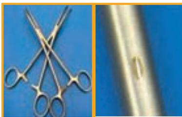
Corrosion de contact : acier inox/acier inox.
