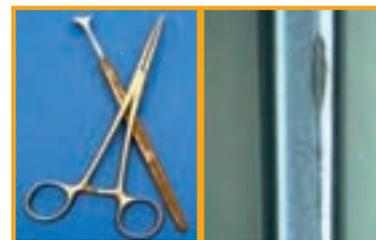
Corrosion de contact : acier inox /laiton
