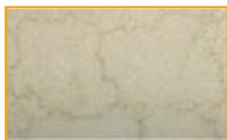
Dessin en tacheté dû aux impuretés dans le condensat de vapeur
