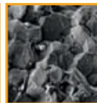
Détail : Cassure de mâchoire d'une pince avec structure de rupture typique : grumeleuse et intergranulaire
