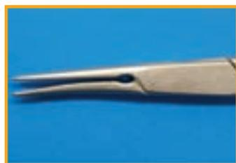
Déformation due à une manipulation non conforme
