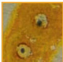
Sel de régénération de forte teneur en chlore causant la corrosion par piqûres sur la surface d'instrument.
