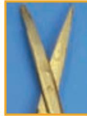
Paire de ciseaux rouillée en acier inoxydable. Cause : dommage causé par une attaque acide, déclenchée par un surdosage du produit de nettoyage.
