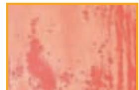
Attaque importante du matériau sur les surfaces en aluminium avec anodisation incolore et en couleur sur un support d'instruments et des conteneurs. Cause : surdosage de la solution de lavage alcaline autrement compatible.
