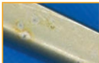
Piqûres de corrosion induites par le chlorure sur l'instrument
