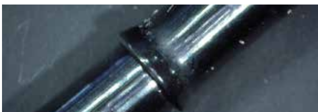
Ineinandergestülpte Falte am Einführungsteil
