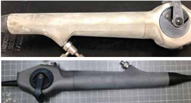
Beschädigung der Eloxalschicht am Bedienteil
