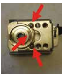
Korrosion am Adapter
