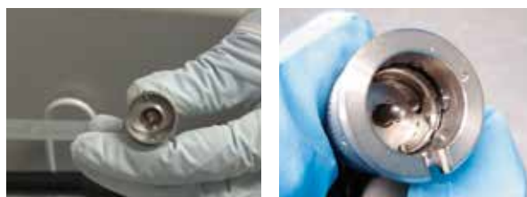
Feuchtigkeit im Dichtheitstester-Anschluss
