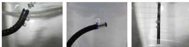
Beschädigung des Außenmantels
