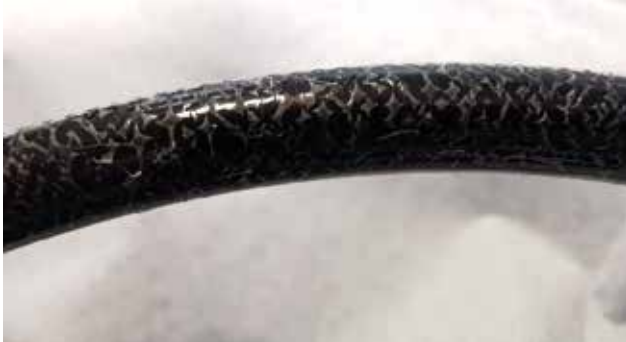
Ablösen der Oberfläche am Einführschlauch
