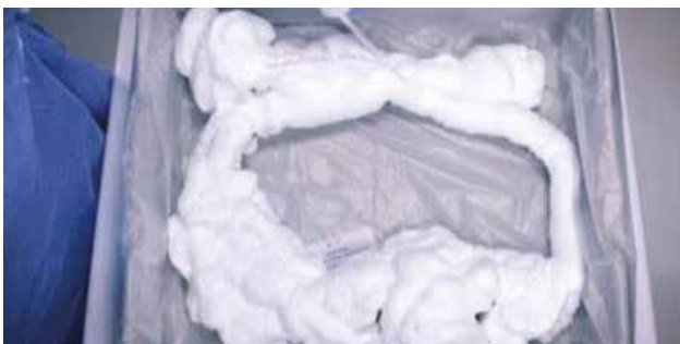
Nutzung von Schaumspray zur "Feuchtentorgung"
