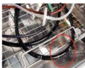
Einführteil ragt aus dem Korb
