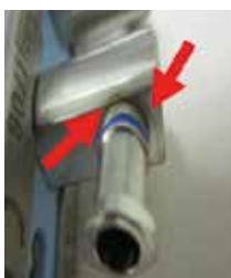
Korrosion am Adapter
