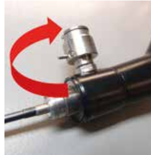
Dichtheitstester frei drehend
