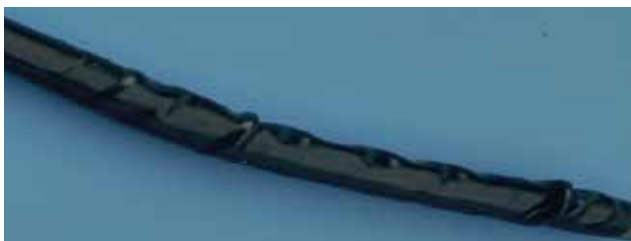
Faltenbildung am Einführungsteil durch zu starkes Abziehen Richtung distalem Ende
