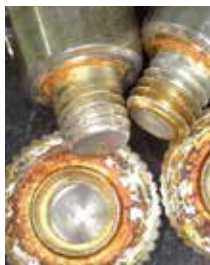
Korrosion am Hahnreiber
