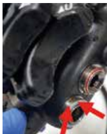
Korrosion am Ventilgehäuse
