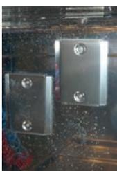
Corrosion du laveur-désinfecteur d'endoscope
