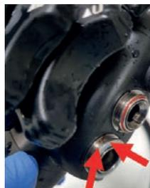
Corrosion de la cage de pistons
