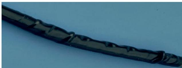
Formation de plis sur la gaine d'introduction dues à une traction excessive vers l'extrémité distale
