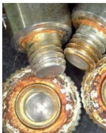
Corrosion du connecteur de robinet
