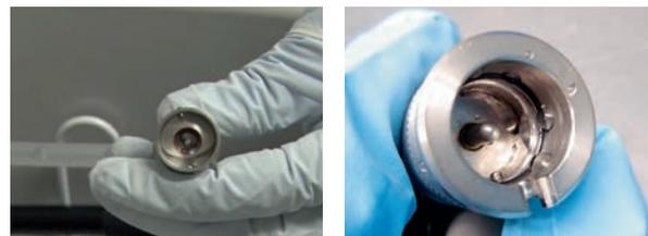
Humidité dans le raccord du testeur d'étanchéité
