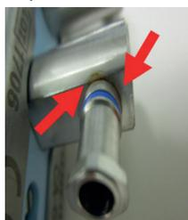
Corrosion de l'adaptateur
