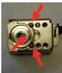
Corrosion de l'adaptateur
