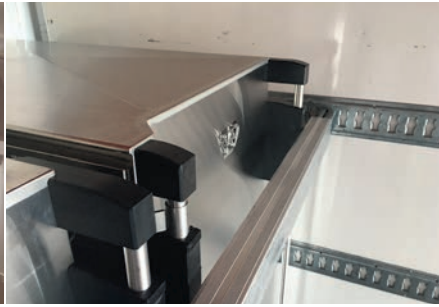
Abb. 12: Ladungssicherung, längs (Detail)
