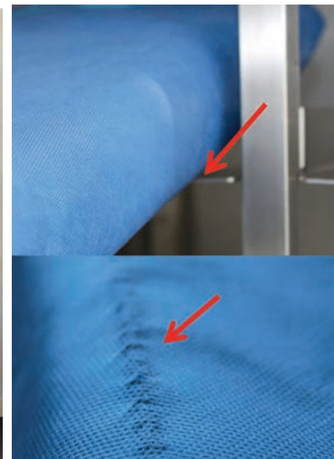
Abb. 9: mögliche Beschädigung durch unsachgemäße Lagerung
