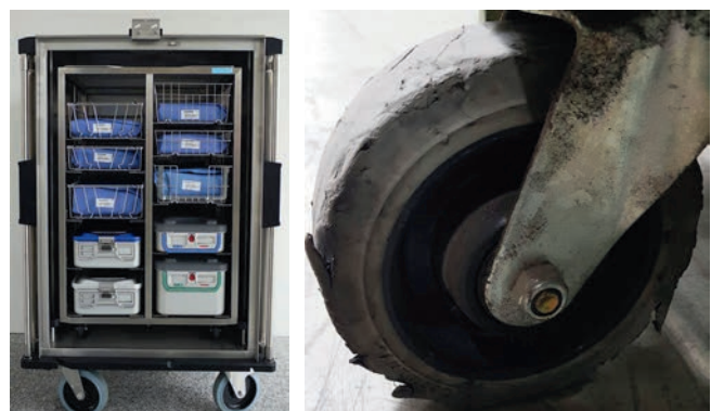
Abb. 3: Lagerung mit Schienensystem Abb. 4: Beschädigte Rolle
