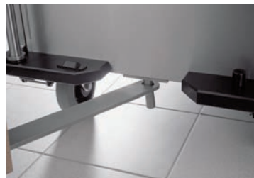
Abb. 7a/b: : Detail Kupplung und Deichsel, sowie Aneinanderkoppeln
