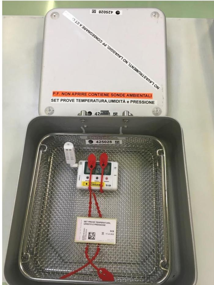
Verwendet, der Sonden zur Messung von Temperatur, Druck und Feuchtkalt während des Transports von sterilen MPs.
