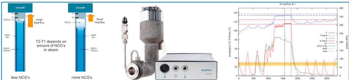
Figure 14. Système NGC400 Sensor développé par la société hollandaise SolidToo (qui équipe en OEM les stérilisateurs du fabricant Steelco) pour le contrôle en temps réel de la concentration de gaz non condensables (corrélée à la chaleur dissipée mesurée lorsque la vapeur se condense contre la paroi interne du capteur).
