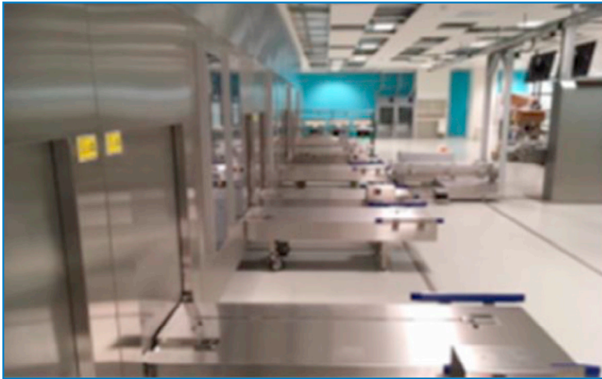
Figure 29. Navette avec rampes de chargement des stériliseurs MMM.
