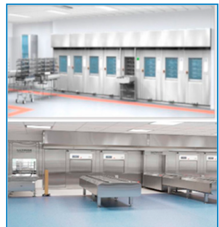
Figure 32. AGS 2.0 (Air Glide Système) de Getinge pour LDI et stériliseurs.
