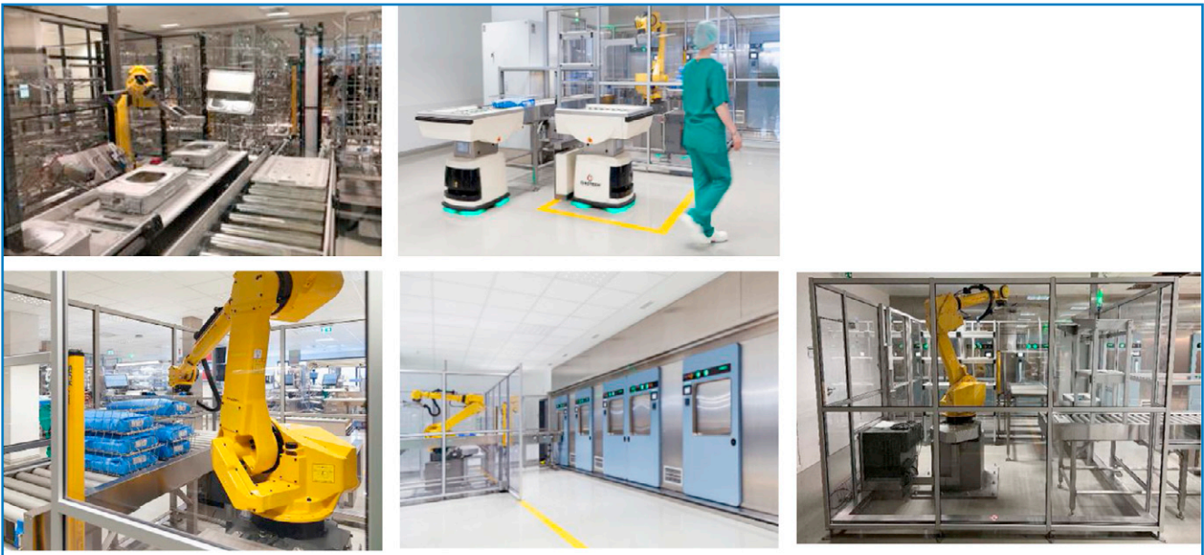
Figure 38. Solution de robotisation de l'intégrateur GIBOTECH pour saisir et déplacer et répartir des contenant et des charges avant et après stérilisation (UKSH-Danemark).
