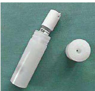
Der so verpackte Bioindikator wird danach zusammen mit 2 Silikon-Noppenmatten (die zusätzlich viel  $H_2O_2$  absorbieren) in einem Klarsichtbeutel für Niedertemperaturverfahren, wie hier im Bild, platziert. Diese Einheit stellt das sogenannte PCD dar.
