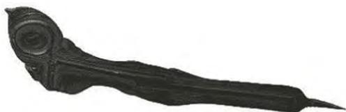
Dies geschieht bei sehr hohen Temperaturen (950–1050 °C). Mit ein paar wenigen Fallhammer-Schlägen wird das Spaltstück in ein Gesenk geschlagen.
