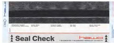
1. Intakte Siegelnaht über die gesamte (festgelegte) Breite gemäss DIN EN ISO 11607-2
