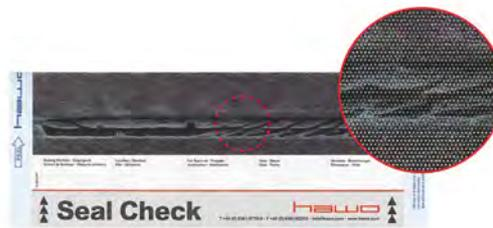
4. Delaminierung oder Ablösung von Materialien / zu niedrige Temperatur oder zu niedriger Anpressdruck
