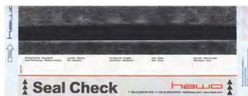
1. Soudure correcte homogène sur toute la longueur conformément à DIN EN ISO 11607-2
